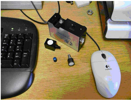
Obr.5 Spektrometr USB2000 s nastavci pro měření radiace v terénních podmínkách
