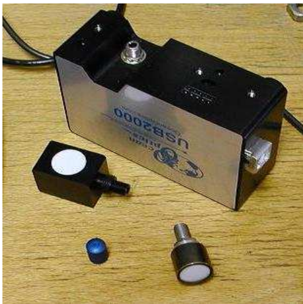
Obr. 1 - spektrometr USB2000 s kosinově korigovanými nástavci vyrobenými v UFP VOD
