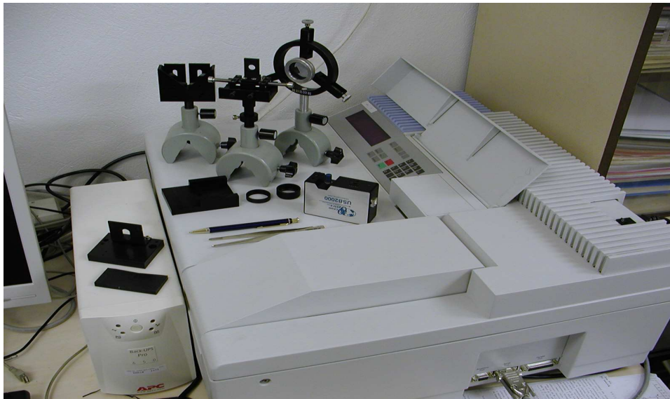
Obr. 2 - porovnání klasického spektrometru s ISS . Na obrázku jsou též vidět některé součásti pro optické lavice a objímky na filtry vyráběné v UFP VOD .
