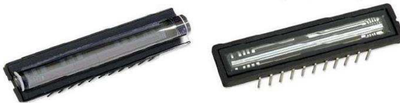
Obr. 3 - Příklad řádkového senzoru bez a se sběrnou čočkou
