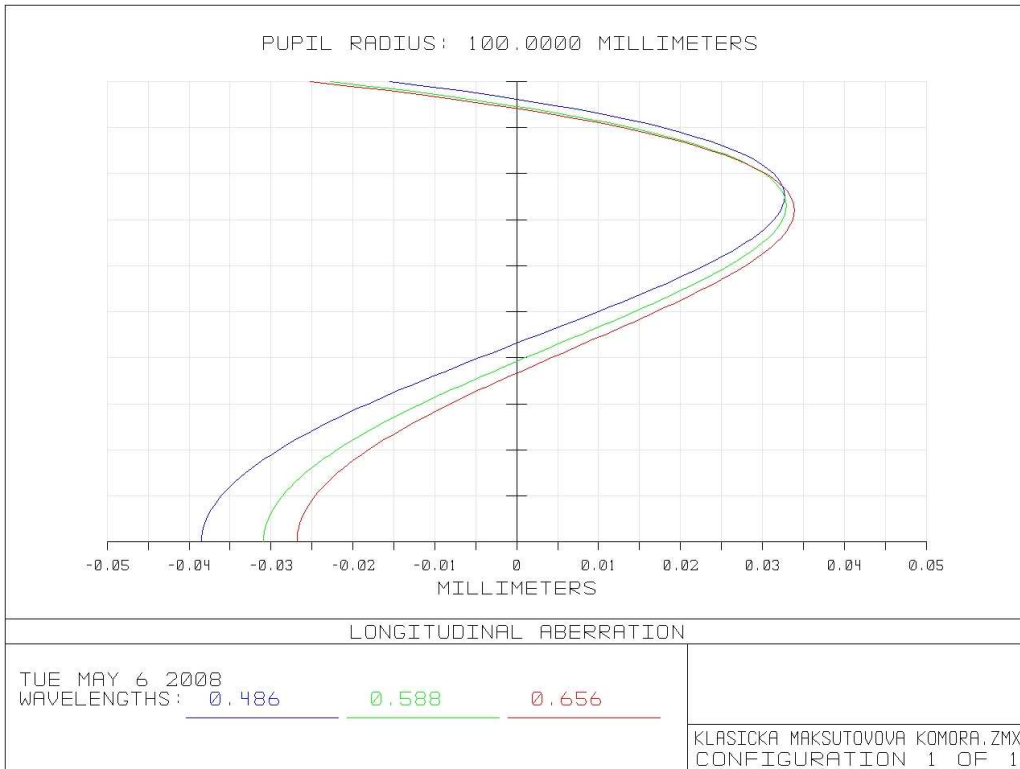
Obr.1. – sférická vada meniskového dalekohledu; pro 3 vlnové délky
