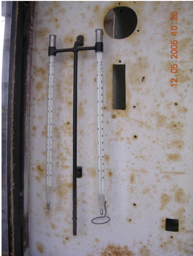
Obr. 2 Původní umístění teploměrů (vlevo) a stav altánku před opravou
