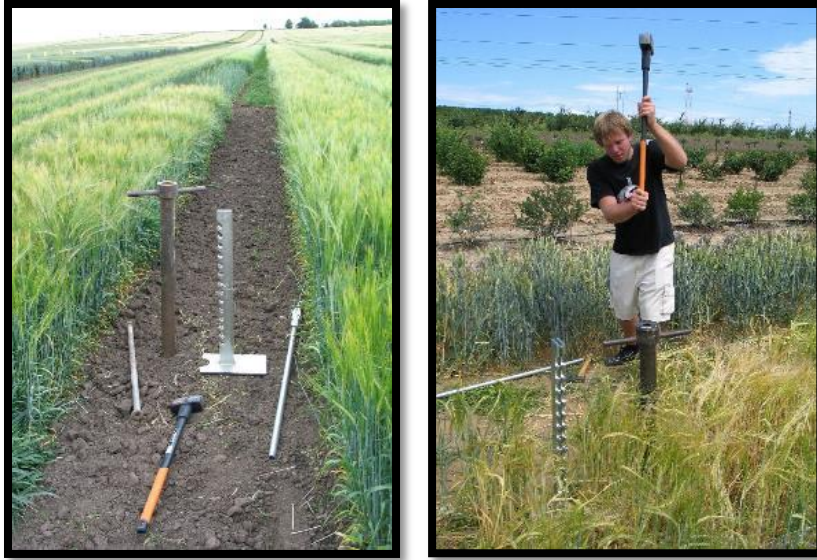
Obr. 2: Souprava na odběr vzorků kořenového systému vyvinutá a používaná na University of Natural Resources and Life Sciences, Vienna a na Mendelově univerzitě v Brně.
