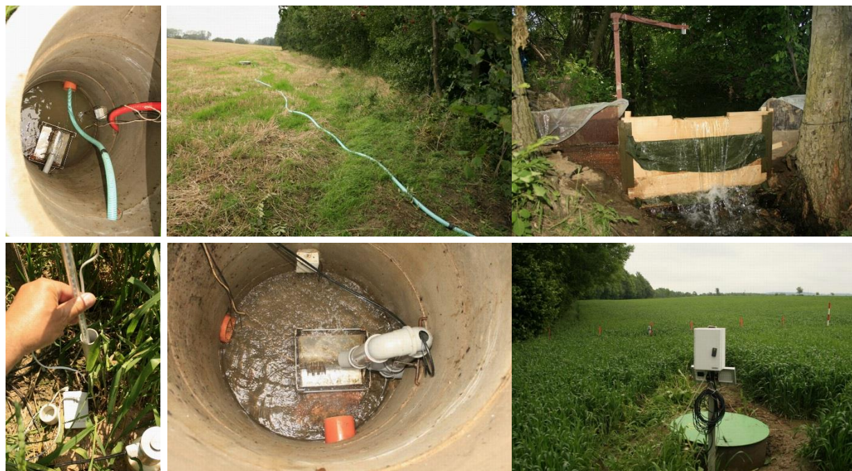
Obr.1b Fotodokumentace vybavenosti objektů experimentální plochy Nahore: Š3 (měření přítoku ze ZD, zaústění N); násoska N; hrazení nádrže VN a měření hladiny
