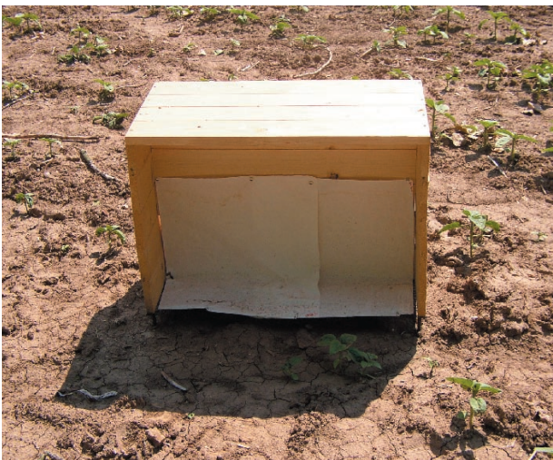
Obr. 1.1 Erodometerné zariadenie (zjednodušený náčrt a umiestnenie v teréne)
