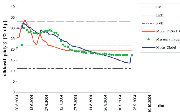
Obr. 3 Merané a modelované hodnoty objemovej pôdnej vlhkosti v lokalite Koliňany v roku 2004, BV – bod vädnutia, BZD – bod zníženej dostupnosti, PVK – poľná vodná kapacita
