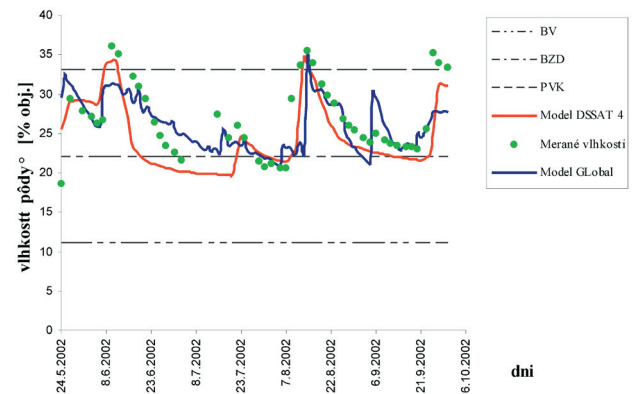
Obr. 1 Merané a modelované hodnoty objemovej pôdnej vlhkosti v lokalite Koliňany v roku 2002, BV – bod vädnutia, BZD – bod zníženej dostupnosti, PVK – poľná vodná kapacita
