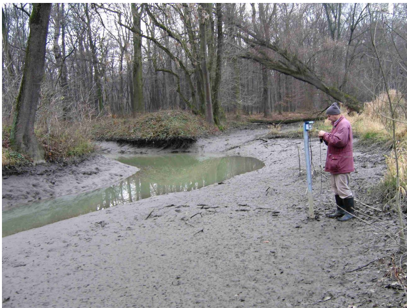
Obr. 6. Ukázka minimálního vodního stavu, při kterém se teplotní čidlo dostává mimo tekoucí vody v toku Spářovka. Na obrázku je zachyceno původní umístění pažnice s teplotním čidlem. Po zjištění rozsahů kolísání hladiny v toku Spářovka byla pažnice přesunuta do největší hloubky toku.
