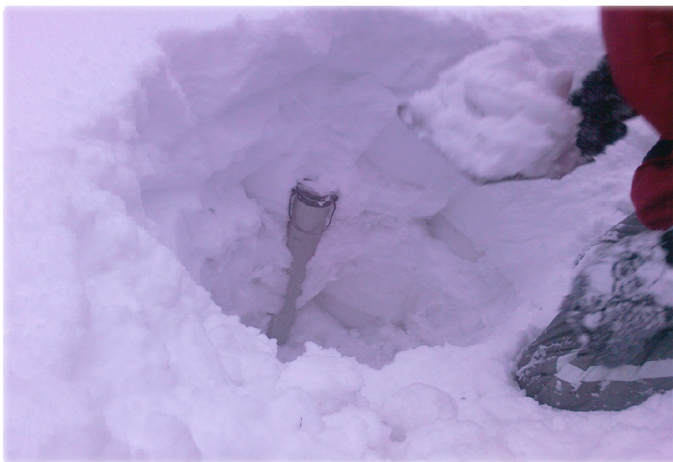
Obrázok 6: Odoberanie vzoriek snehomermom typu VS-43
