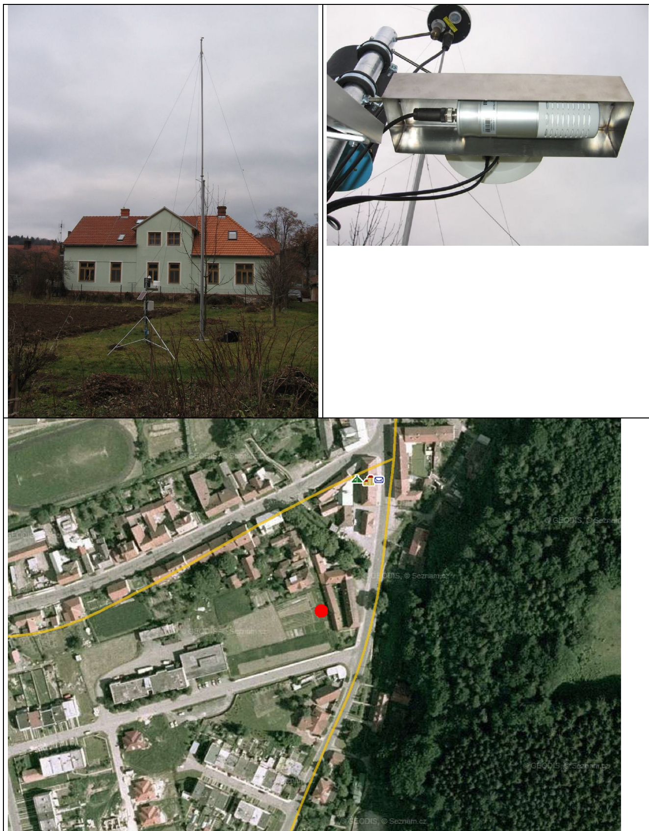
Obr. 1 Pohled na meteorologickou stanici ve Sloupu a její umístění, vpravo nahoře detail snímače CO 2
