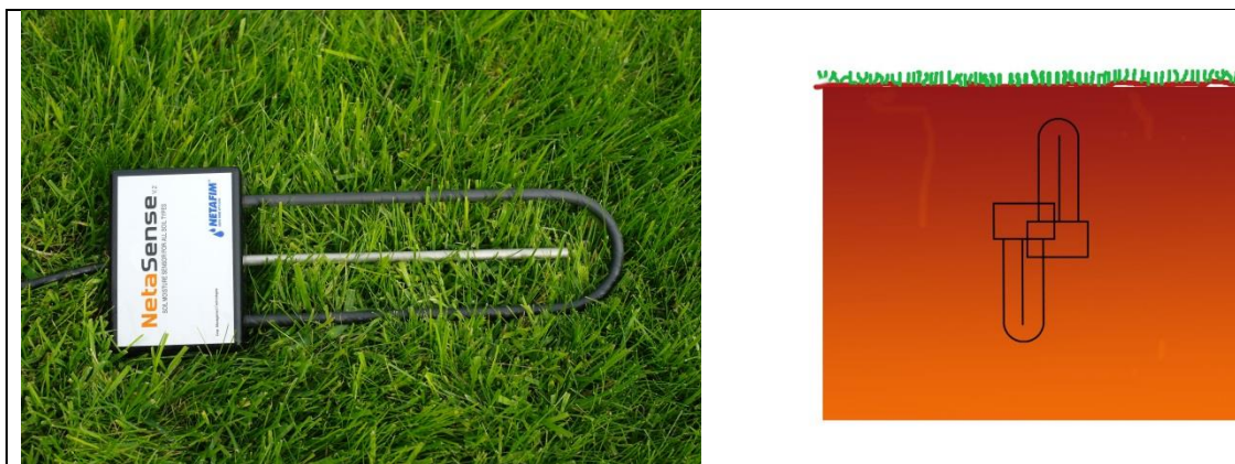
Obr. 1 Snímač půdní vlhkosti a schéma umístění dvou snímačů svisle nad sebou, použité v pokusu
