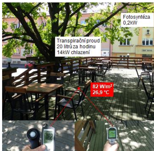
Obr. 5. Intenzita slunečního záření na osluněném chodníku je 877 \text{ W} \cdot \text{m}^{-2} a povrchové teploty 51,2 \text{ }^\circ\text{C} . Ve stínu stromu je intenzita slunečního záření 82 \text{ W} \cdot \text{m}^{-2} a povrchová teplot 26,9 \text{ }^\circ\text{C} . Při transpiračním toku 20 litrů za hodinu chladí strom sebe a své okolí výkonem 14 \text{ kW} .
