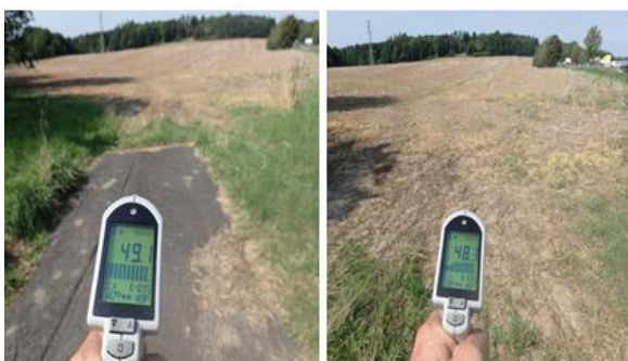
Obr. 6. Benešovsko 26. 8. 2017, intenzita dopadajícího slunečního záření 650 \text{ W} \cdot \text{m}^{-2} . Srovnání povrchové teploty asfaltu ( 49,1 \text{ }^\circ\text{C} ) a navazujícího sklizeného pole ( 48 \text{ }^\circ\text{C} ). Měřeno okolo 15:00 SEČ
