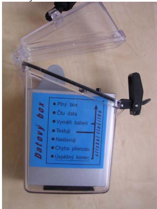
Obr. 4 Datový box k přenosu údajů ze stanice do počítače
