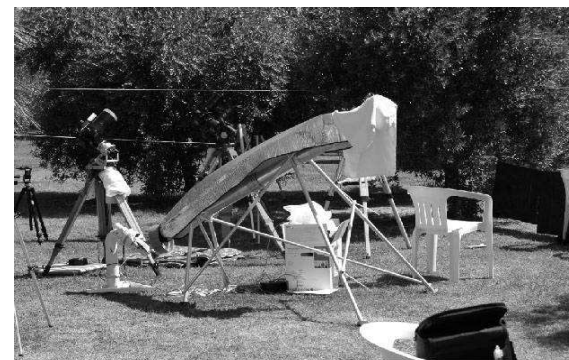
Obr. 1. Pohled na dalekohled 1875/100 mm ve spojení se siderostatem v mimoosovém uložení
