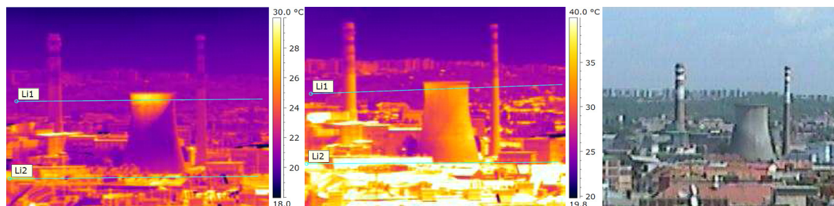
Obr. 1: Výstup ze snímkování termokamerou - dopolední snímek (vlevo), odpolední snímek (uprostřed) a identická scéna nafocená klasickým fotoaparátem (vpravo)
