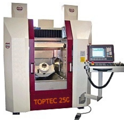
Obr. 2 Hrubovací a lapovací stroj k realizaci asférických ploch
