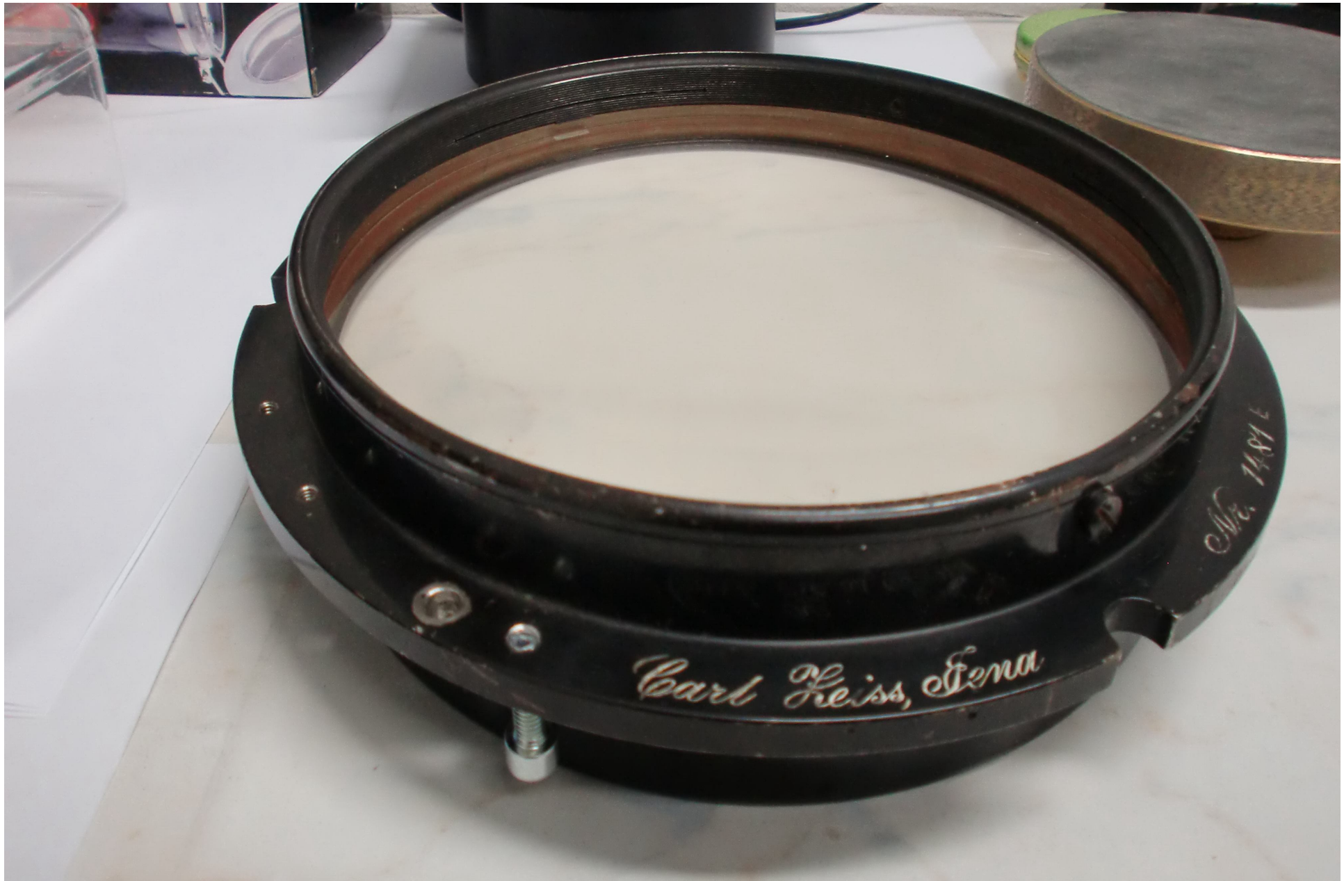
Objektiv Carl Zeiss Jena Nr. 1481 o parametrech 210/3450
