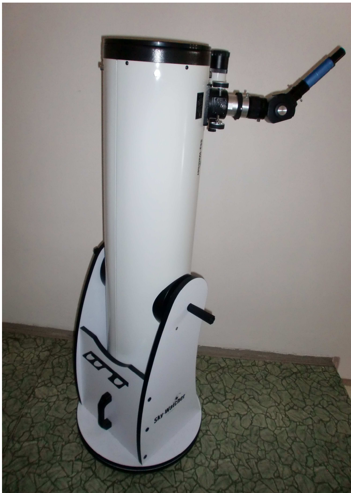
Obrázek 5. Sestava Newtonova dalekohledu se spektroskopem.
