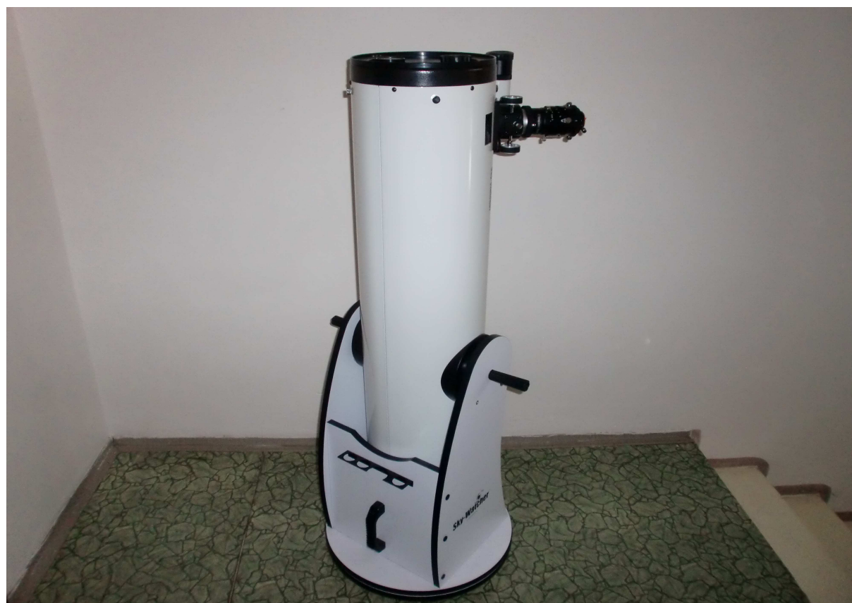
Obrázek 3. Dalekohled Skywatcher 250/1200 s korektorem komy Paracorr 2.
