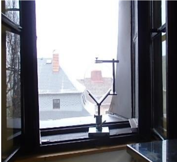
Obrázky 8 a 9. Porovnání úhlového zvětšení plankonvexní čočky o průměru 180 mm a ohniskové vzdálenosti f = 2080 mm na objektu, vzdáleném cca 40 m. Zvětšení cca 5 krát
