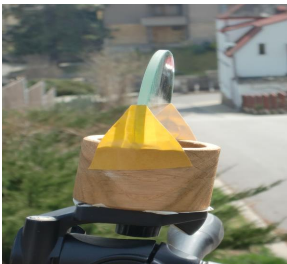
Obrázky 6 a 7. Uchycení čoček o ohniskových vzdálenostech 5000 a 30 000 mm na fotografický stativ pomocí oboustranné lepenky.
