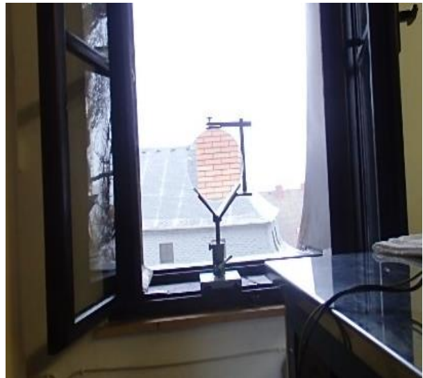
Obrázky 8 a 9. Porovnání úhlového zvětšení plankonvexní čočky o průměru 180 mm a ohniskové vzdálenosti f = 2080 mm na objektu, vzdáleném cca 40 m. Zvětšení cca 5 krát
