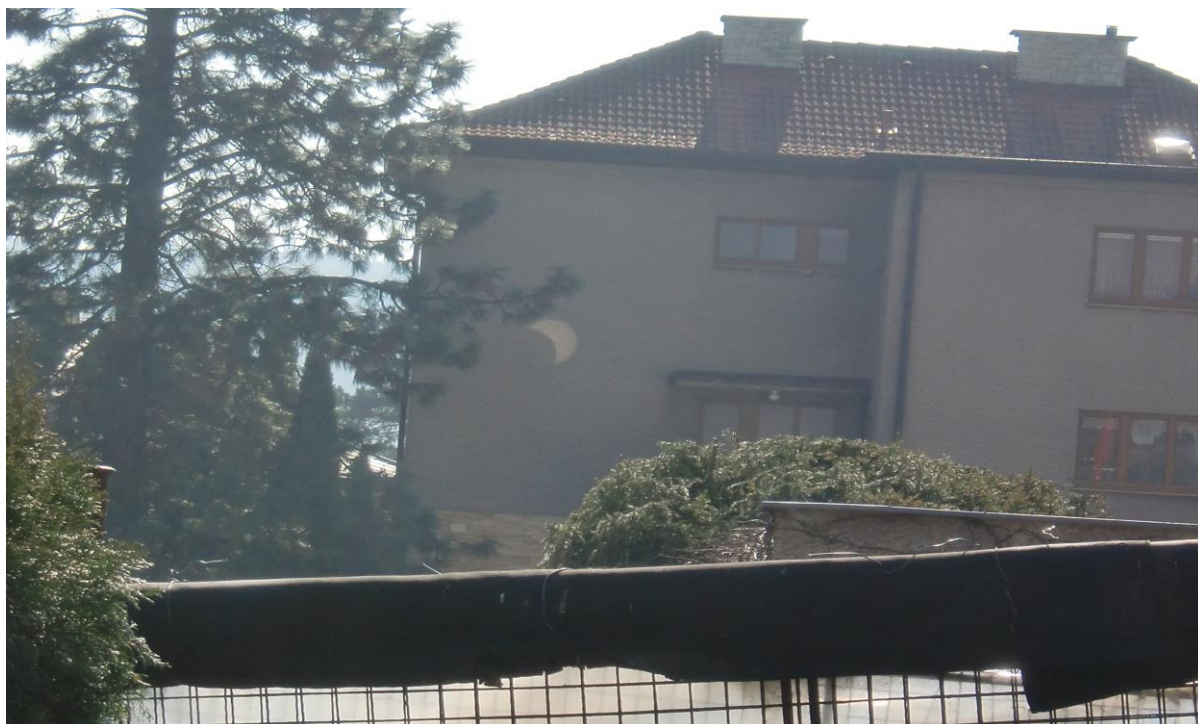
Obrázek 1. Fotografie obrazu Slunce při zatmění 20.3.2015, realizované rovinným zrcadlem 100*100 mm. Vzdálenost obrazu je 75 m.
