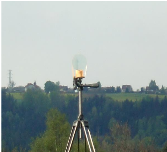
Obrázky 6 a 7. Uchycení čoček o ohniskových vzdálenostech 5000 a 30 000 mm na fotografický stativ pomocí oboustranné lepenky.
