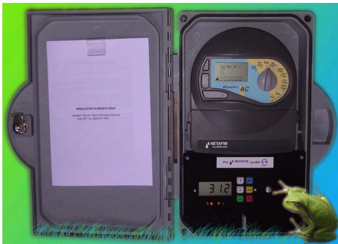
Obr. 9 Časovací zařízení Miracle doplněné o regulátor půdní vlhkosti – závlaha probíhá jen tehdy, je-li půdní vlhkost nižší než nastavená
