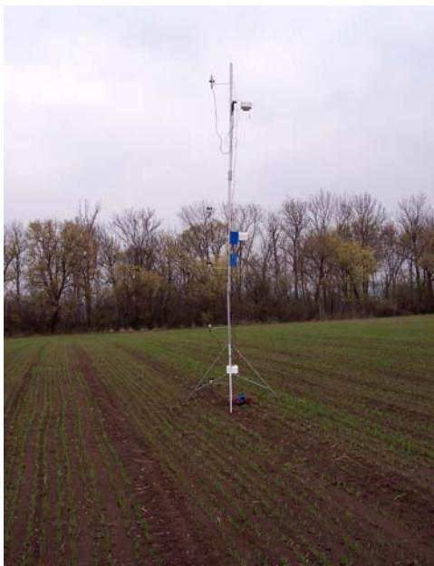
**Obr. 4:** Měření horizontálního profilu větru
