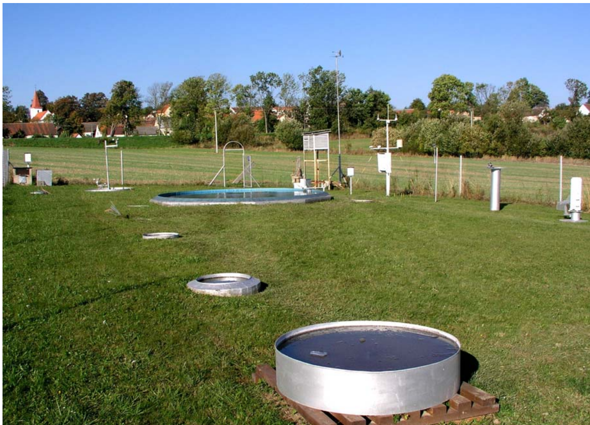
Obr. 2 Výparoměry Class-A, GGI 3000, v pozadí srovnávací výparoměr a meteorologické přístroje
