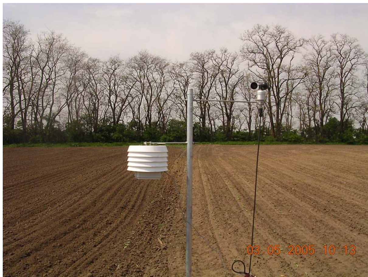
Obr. 5 Měření rychlosti větru, teploty a vlhkosti vzduchu ve výšce 2 m na závětrné straně větrolamu
