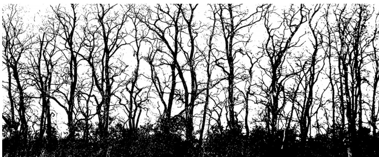
Obr. 2d – větrolam znázorněný pomocí černé a bílé vhodný k stanovení optické porosity
