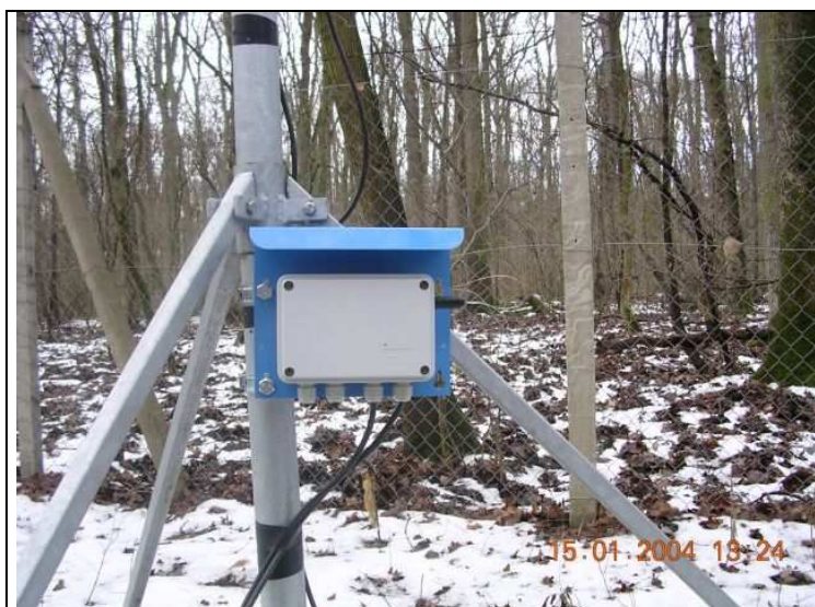
Detail umístění VIRRIBLOGGERu na stanici v lese
