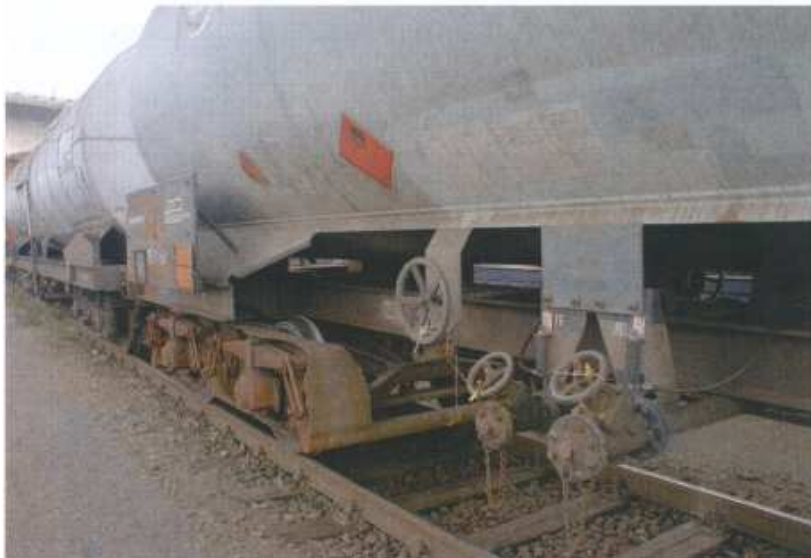
Obrázek 2: Detailní pohled na přečerpávací armatury u železničních cisteren (8).
