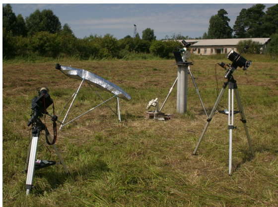
Obr 3.: Pozorovací stanoviště v době přípravy experimentů (vlevo) a během úplné fáze zatmění (vpravo). Pro snímání bílé koróny byly použity dalekohledy s ohniskovými délkami od 200 mm do 1875 mm, umístěnými na paralaktických montážích, nebo napájených siderostatem v mimoosovém uložení (dalekohled f=1875 mm).
